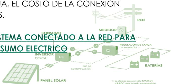
ADOPTAMOS 10 PANELES, LOS CUALES PRODUCEN 12.000 W h, ESTE VALOR EQUIVALE A UN 74% DEL CONSUMO DIARIO, ELIMINAMOS LA UTILIZACION DE BATERIAS, DEBIDO A QUE EL SISTEMA SOLO ABASTECERA PARTE DEL CONSUMO, LA OTRA PARTE SERA TOMADA DE LA RED.
