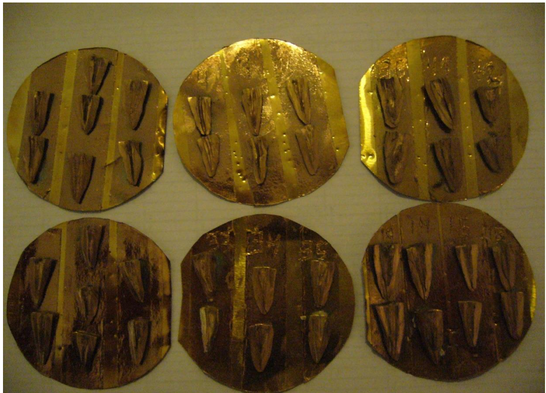
Figura 17. Las muestras metalizadas en los discos
