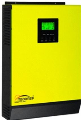
Teniendo en cuenta el Rango MPPT aportado con el fabricante del inversor-cargador los paneles se deben conectar en 4 paneles en serie y generar así 3 grupos que se conectarán en paralelo. De esta manera se logra una tensión de 110,1V en el peor de los casos y una corriente máxima de 34,84A.
