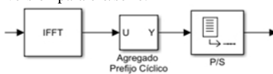
Figura 19. Bloque IFFT e inserción del prefijo cíclico (Propio)
