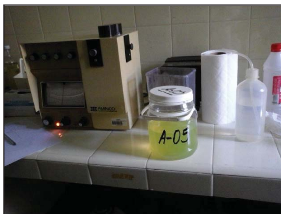
Figura 4.- Fluorómetro marca Aminco (laboratorio de agua - CECOAL)
