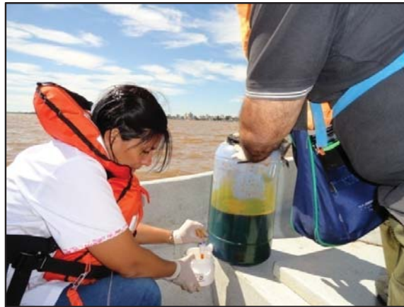
Figura 1. Toma de muestras del trazador antes del ensayo
