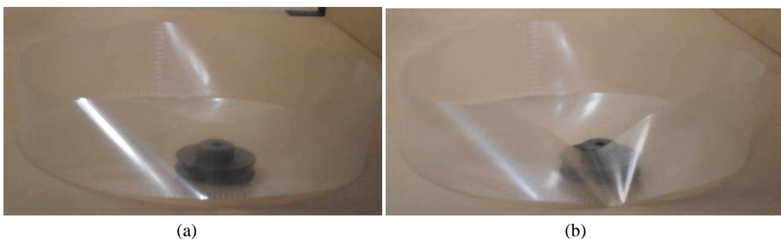
Figura 24: Deformación del modelo (pesa 0,5r) a: (a) 78 Km/h; (b) 94 Km/h.
