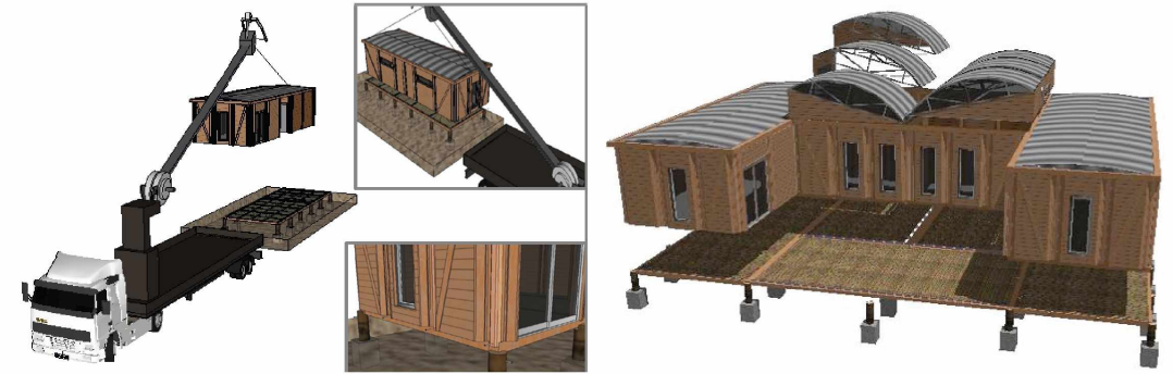
Figura 4: Sistema constructivo de células 3D a partir de vagones de tren en desuso realizado por la alumna Natalia Santi, 2009.
