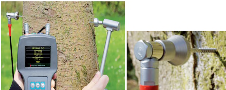
Figura 6: medición de la resistencia a la perforación. Fuente: IML-RESISTOGRAPH. www.imlusa.com
