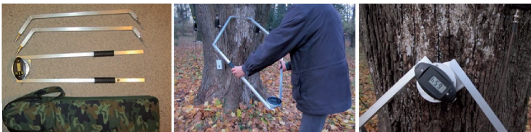
Fig. 8: Calibres para medir por ondas ultrasónicas. Fuente: ArborSonic Caliper. http://www.fakopp.com/site/node/36
