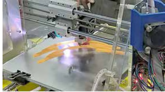
Figuras 6 y 7. Actividad: impresión en 3 dimensiones de los proyectos. Hardware: impresoras 3D con material PLA (filamentos plásticos color). Software: Slic3r / Cura / Simplify. Fuente: elaboración propia
