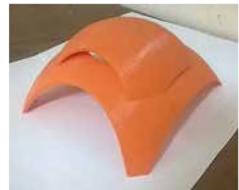
Figuras 8 y 9. Panel de presentación y modelo impreso en 3D con PLA (filamentos plásticos). Tipología: cúpulas. Técnica constructiva: cáscaras de hormigón armado. Fuente: elaboración propia
