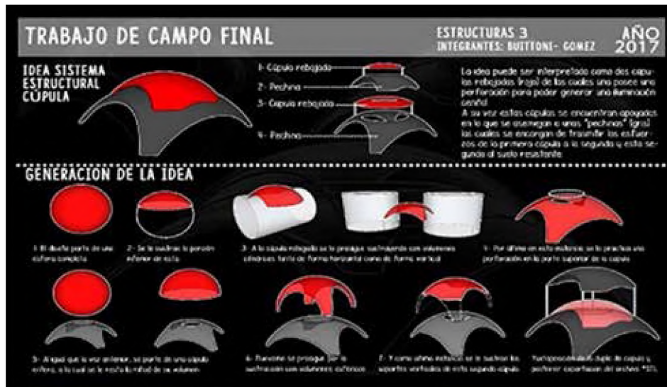
Figuras 8 y 9. Panel de presentación y modelo impreso en 3D con PLA (filamentos plásticos). Tipología: cúpulas. Técnica constructiva: cáscaras de hormigón armado. Fuente: elaboración propia
