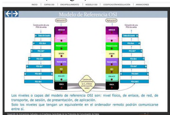
Figura 8: Pantalla sección modelo OSI. Sección Codificación-Modulación: Se puede ver el proceso por el cual el mensaje que sale desde la capa de aplicación se transforma en trama y cambia de estado.
