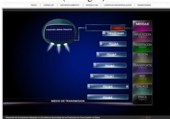
Figura 7: Pantalla sección encapsulamiento. Sección modelo OSI: Cómo surge y evoluciona el modelo OSI; es una introducción al modelo de referencia desde sus inicios (ver Fig. 8).
