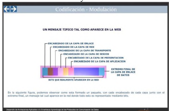
Figura 9: Pantalla sección codificación-modulación. Los datos digitales de la trama son codificados, modulados y convertidos en
