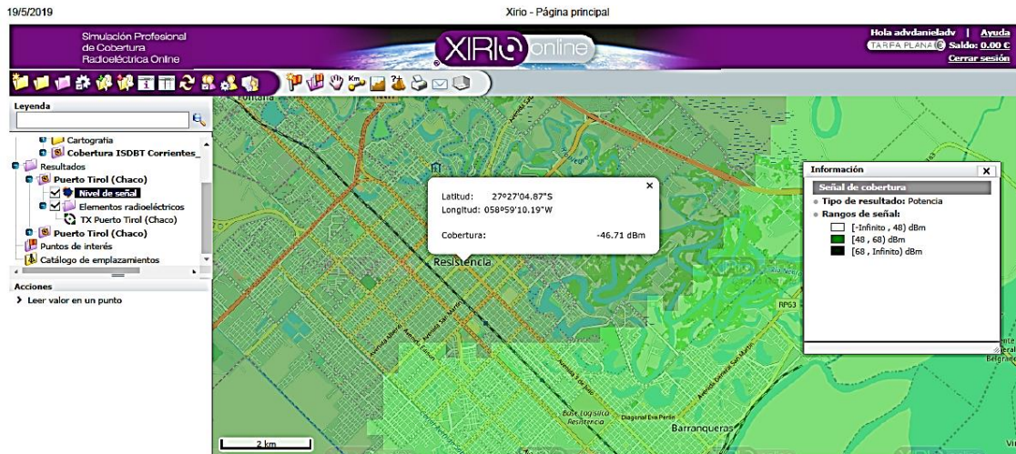
Figura 8.8.- Nivel de potencia de cobertura transmisor Puerto Tirol en la ciudad de Resistencia (XIRIO® Online) [15].
