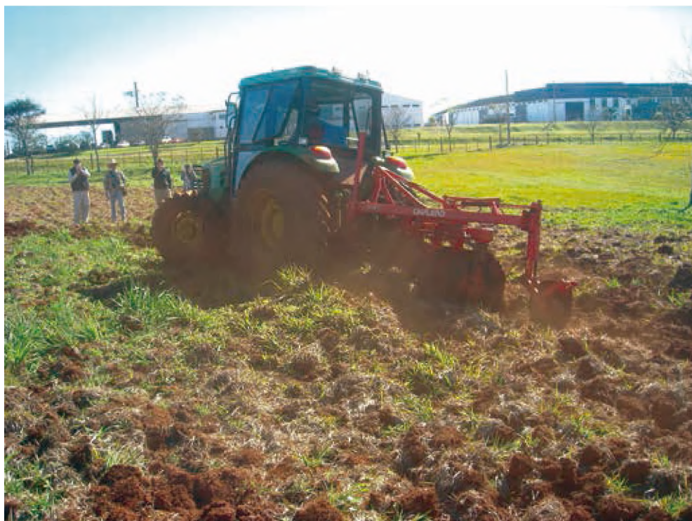
Figura 3: Tractor con arado de discos reversibles.
