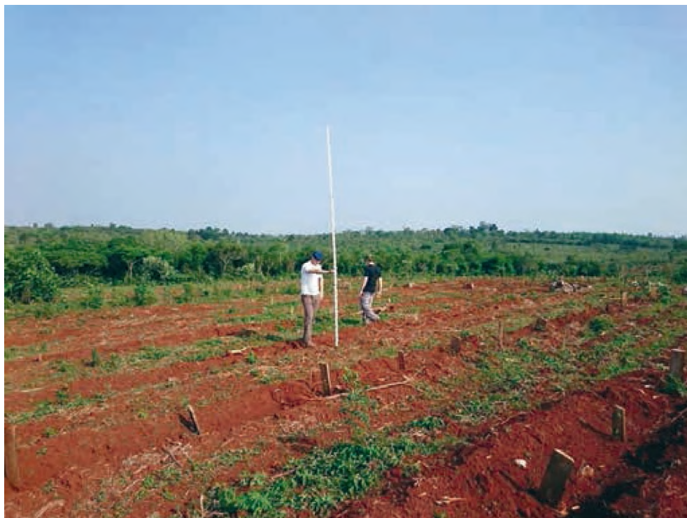
Figura 6: Nivelación con nivel óptico y mira parlante desplazándola hasta la cota del intervalo vertical.
