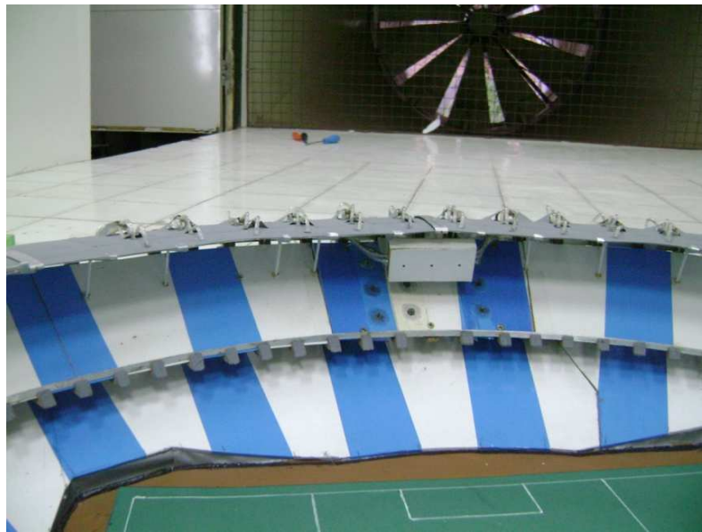
Figura 8. Detalle del montaje de tomas de presión sobre la cubierta y la pantalla.
