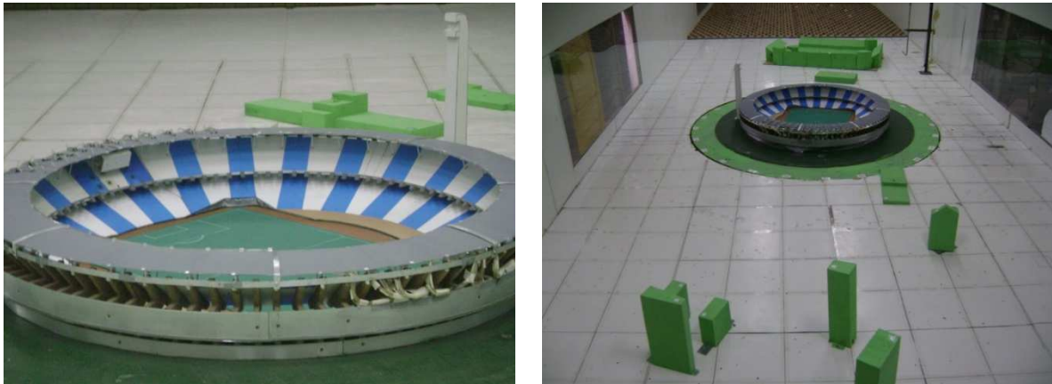
Figura 4. Modelo del estadio de Racing Club y reproducción del entorno inmediato en la cámara de ensayos del túnel de viento.
