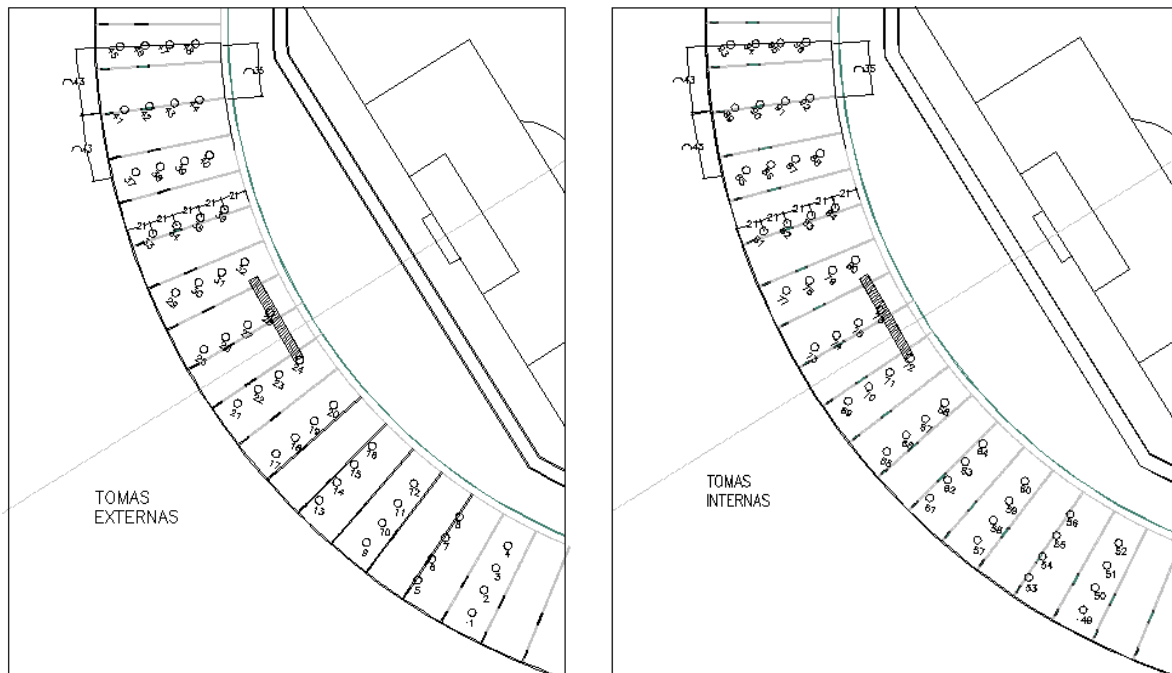
Figura 6. Detalle de la ubicación de las tomas de presión sobre la cubierta del estadio.
