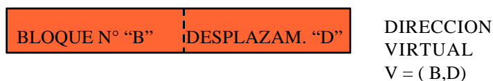
Figura 3.16: Formato de la dirección virtual dentro de un sistema de transformación de bloques.
