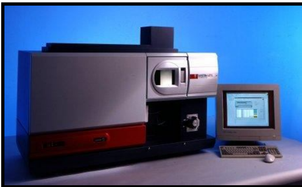
Figura 4.5. Espectrómetro ICP-OES Varian Vista-PRO radial (Laboratorio Alex Stewart, en la localidad de San Martín, Mendoza, Argentina).
