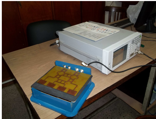
Fotografía N° 2: Antena inteligente alimentada a través del generador de RF, marca Agilent Modelo N9310A RF. Rango 9 KHz – 3.0 GHz. Z_{output} = 50 \Omega Observada su radiación en un Analizador de Espectro, instrumento de banda agosta y adecuado para detectar la señal radiada.
