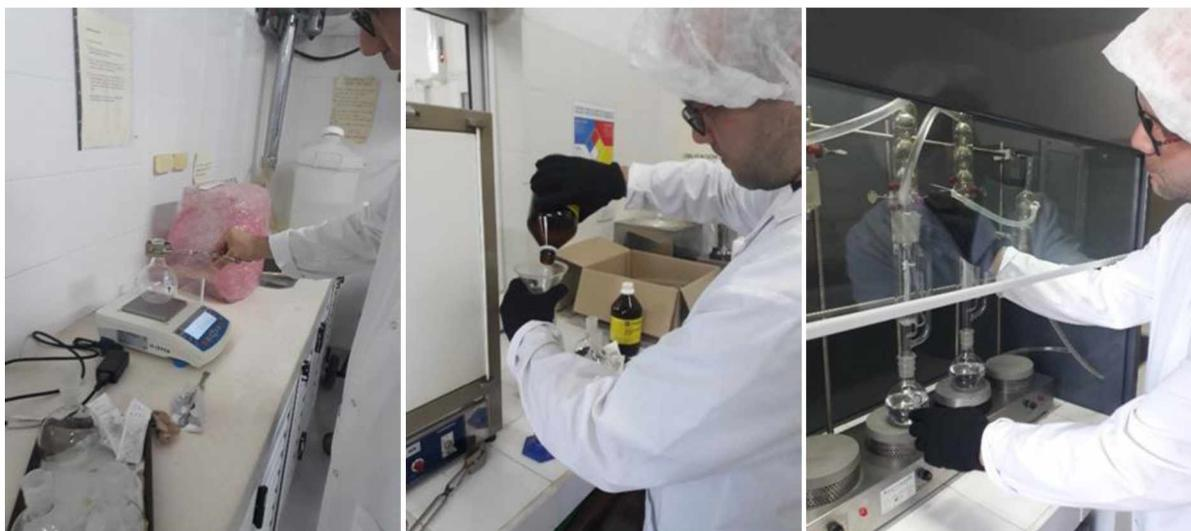
Foto N° 14: Pesado del balón (izq), incorporación del éter de petróleo (cen) y colocación en el extractor de Soxhlet (der)
