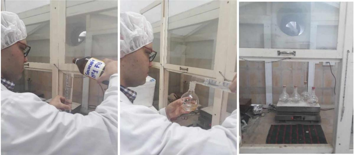
Foto N° 13: Agradado de la Solución 1 (izq) y de la solución 2 (cen) y muestra en manta de hervir (der) para determinar Fibra Bruta.
