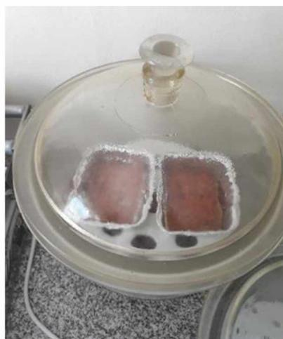
Foto N° 11: Muestras luego de 48hs en estufa (izq) y bandejas en el secador (der)
