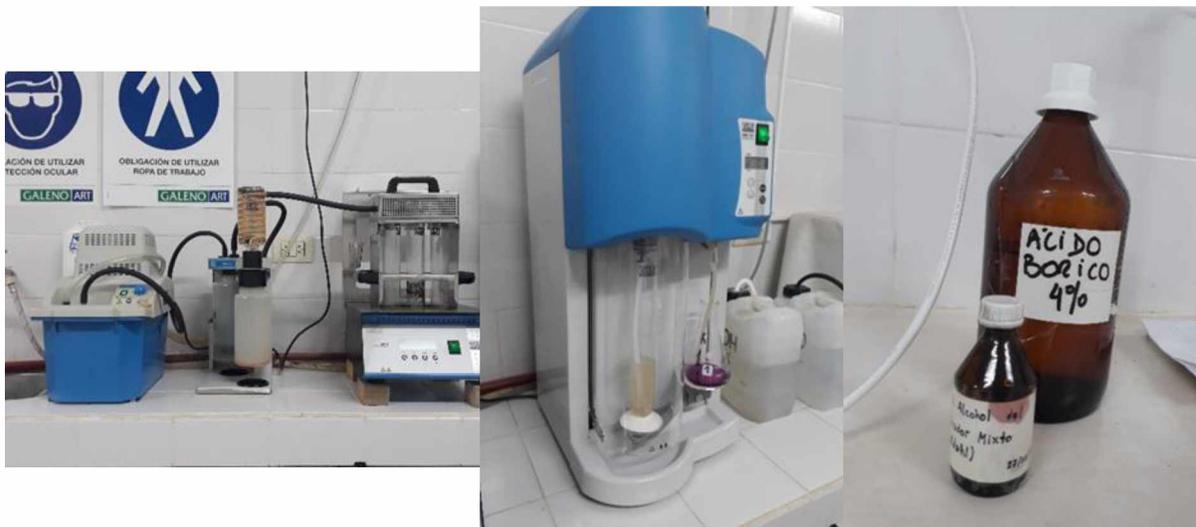
Foto N ° 9 :Digestor (izq), destilador (cen) y ácido bórico al 4% (der)
