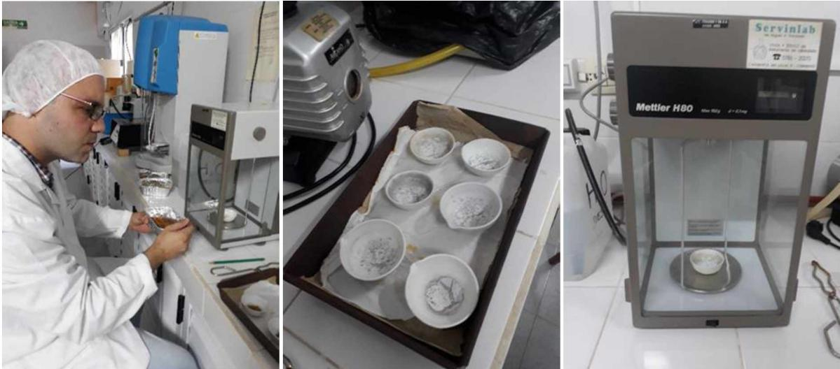
Foto N° 15: Pesado de los crisoles con la muestra (izq), muestra post mufla (cen) y pesado de los crisoles post mufla (der)
