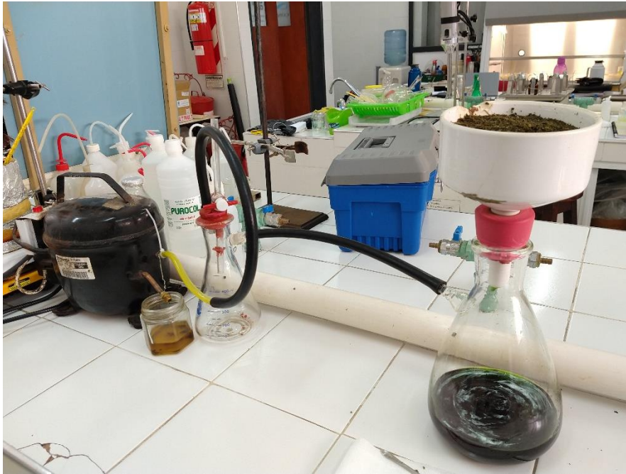
Figura 6: Filtración al vacío del producto obtenido de la maceración.
