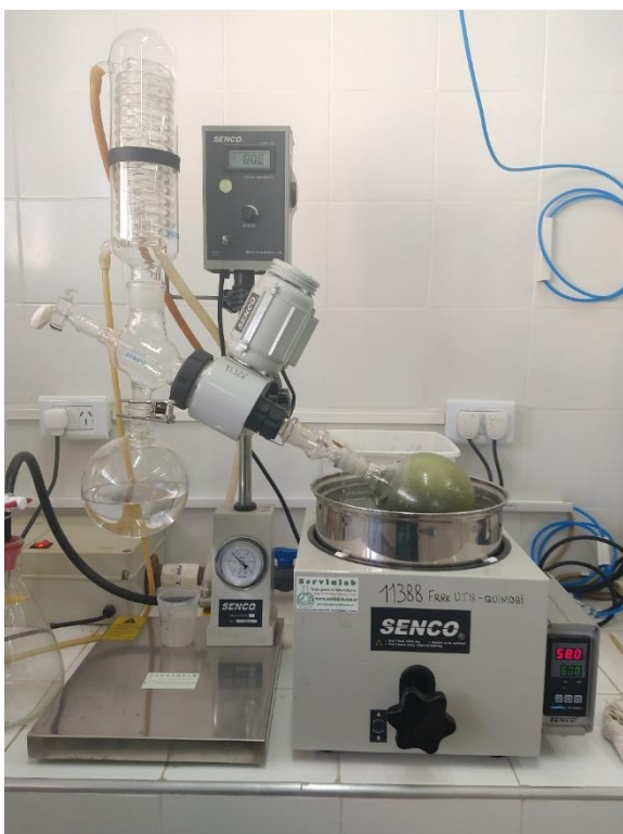
Figura 2: Rotaevaporador (Aparato utilizado para la obtención del extracto)
