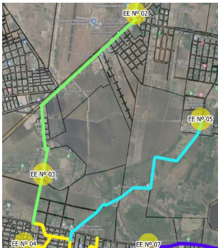
Fig. 8. Estación Elevadora N°3, Estación Elevadora N°5 e impulsiones al Sector Oeste (Fuente: ACSA)
