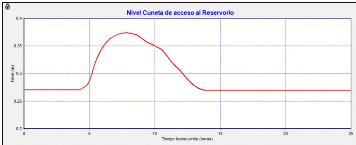
Fig. 66 – Curva Nivel vs Tiempo de cuneta acceso reservorio para evento de 5 años y 75 minutos (tramo entre nodos 1 y reservorio en la topología de fig. 61)
