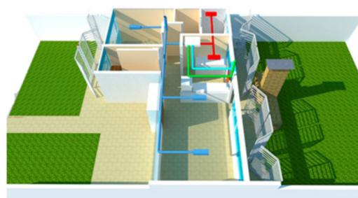
Este es un sistema de ventilación forzada que tiene como objetivo la recuperación de energía utilizada para climatizar un espacio transfiriendo el calor del aire extraído del interior al calor impulsado del exterior. Los intercambiadores de calor, son equipos cuya función es aprovechar las propiedades psicrométricas (temperatura y humedad) del aire que extraemos de nuestra casa e intercambiarlas con el aire de ventilación que impulsamos del exterior.
