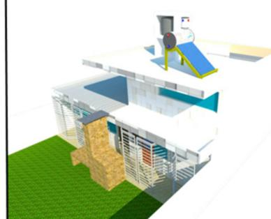
Este sistema es un calentador de agua alterno al calentador de gas o eléctrico, que utiliza como fuente de energía la radiación solar para calentar agua, almacenándola en un termo tanque, el cual provee a la red hidráulica de agua caliente, por lo que disminuye el consumo energético.
