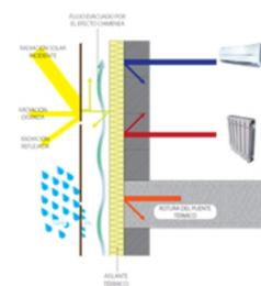
Fachada Ventilada logra una mejora en la aislación termo – acústica, logrando mayor confort y la disminución del consumo energético por el uso de aire acondicionado y calefacción.
