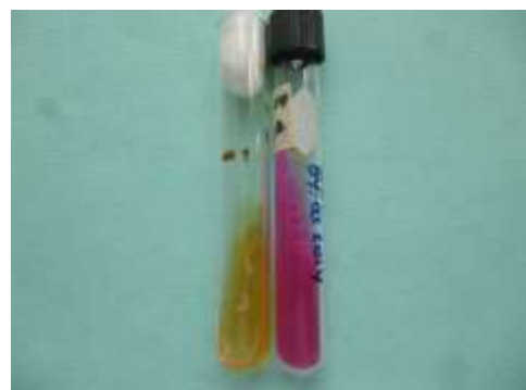
Figura 14. Prueba de ureasa Color fuschia: Ureasa positiva (Foto Fabiola E González C)
