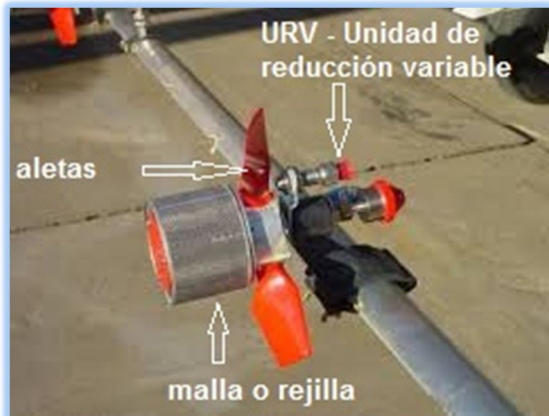
Figura 14. Modelo de aspersor rotativo indicando sus principales componentes.
