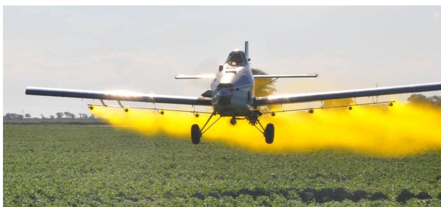
Figura 13. Avión agrícola Ayres Thrush S2R-G6 utilizado en los ensayos.
