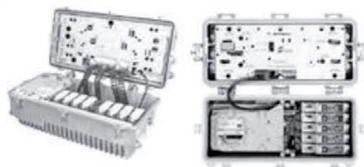
Fig.62. Receptor óptico [Fuente propia].
