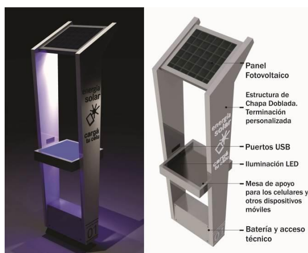
Figura 1 - Diseño del CS desarrollado en el cual se presentan sus aspectos estéticos y técnicos.
