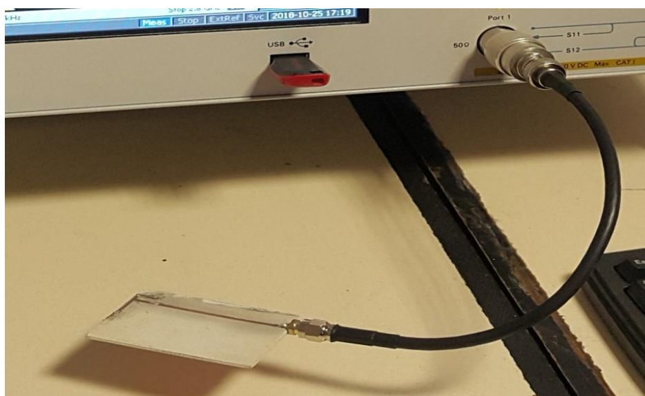
Figura N° 4.14 – Conexión de la antena al Analizador de Redes
