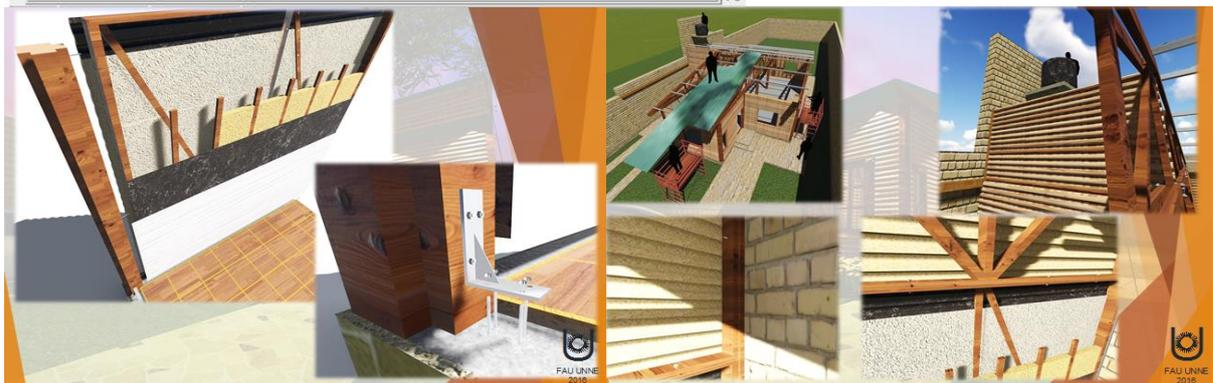
Figura 6. Uso de palmas como material para un sistema constructivo industrializado y prefabricado. Fuente: equipo de alumnos Daldovo, Parigansky y Quijano, ciclo 2016.
