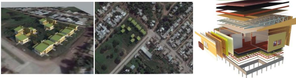
Figura 2. Implantación de la obra propuesta (vivienda) dentro de un conjunto mayor en la ciudad de Resistencia (izquierda y centro) y esquema de despiece del sistema prefabricado diseñado (derecha). Fuente: equipo de alumnos Uriona, Dovis y Pinto, 2016.
