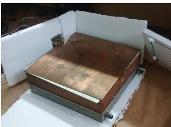
*Figura 8: Aparato de Placa Caliente con la aislación de poliestireno expandido una vez finalizado el ensayo.*
