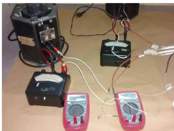
*Figura 9: Equipos de Medición: Amperímetros y Voltímetros para determinación de pci y pce.*
