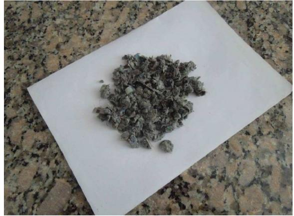
*Figura 4: Producto aislante celulósico obtenido luego de la producción experimental.*
