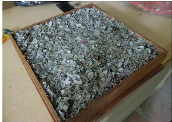
*Figura 6: Proceso de llenado de los ladrillos de ensayo con el material celulósico.*
