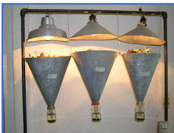
Foto 20. Embudos Tullgren-Berlese utilizados para separar los invertebrados de la hojarasca.
