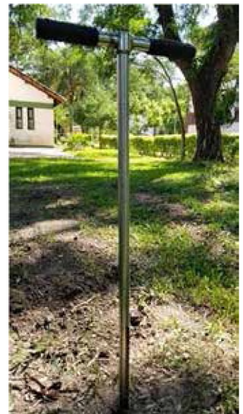
Figura N° 6. Posición correcta del barreno para la toma de muestra.
