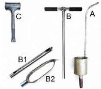
Figura N° 7. Tipos de barrenos. A: para capa arable. B1: tubular. B2: helicoidal. C: mazo o martillo.
