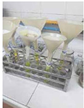
Figura N°3. Filtrado del suelo.
