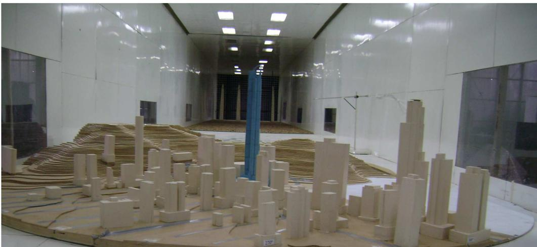
Figura 3. Modelo a escala del edificio incluyendo el entorno urbano y topográfico.
