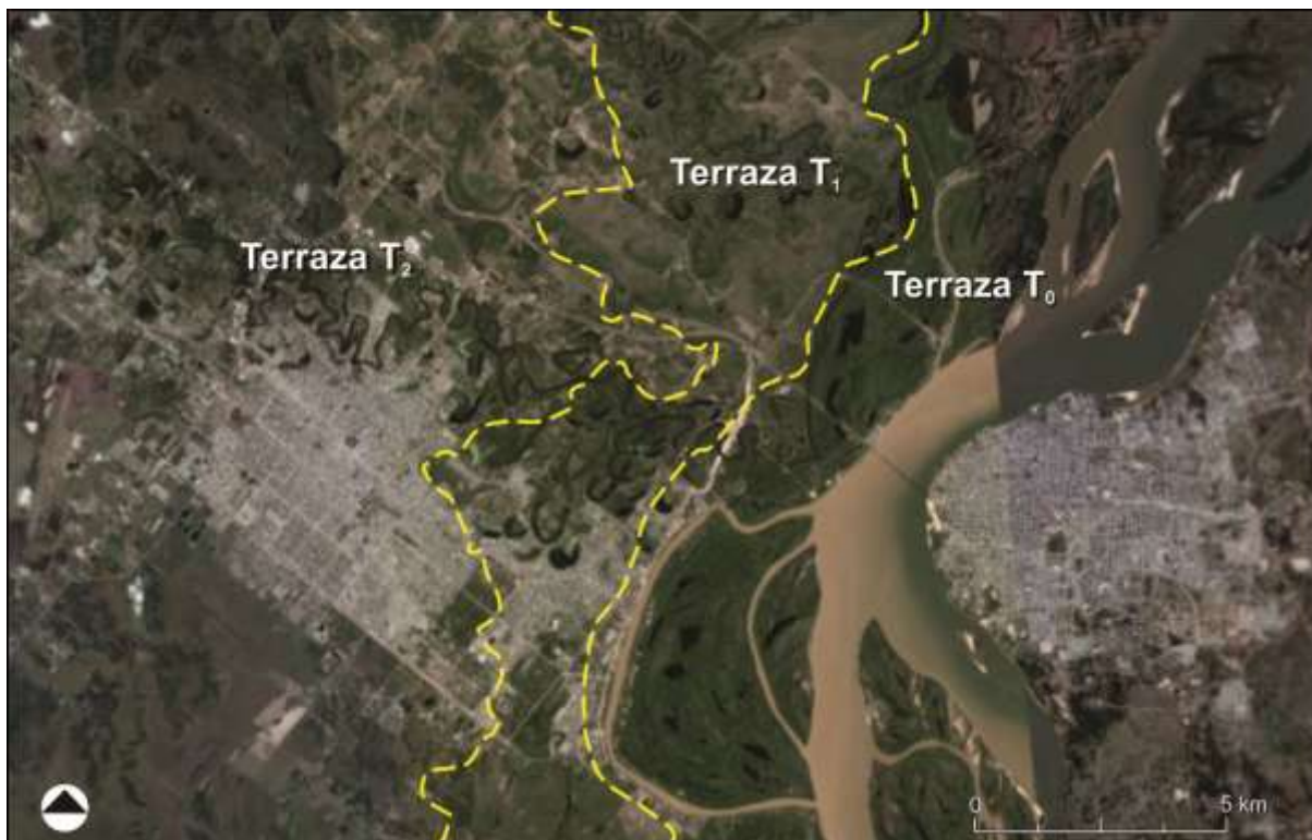
Figura N° 2. Condiciones del sitio. El área delimitada se emplaza sobre una planicie aluvional, de pendiente muy suave, que presenta terrazas fluviales de gran amplitud, denominadas T_0 , T_1 y T_2 , de las cuales se podría decir que la T_1 conjuntamente con la T_2 forman el lecho mayor extraordinario del Río Paraná; ambos niveles en época de crecientes máximas se inundan (Popolizio, E. 1989). Fuente: elaboración propia a partir de Google Earth. kb.google.com . noviembre 2010
