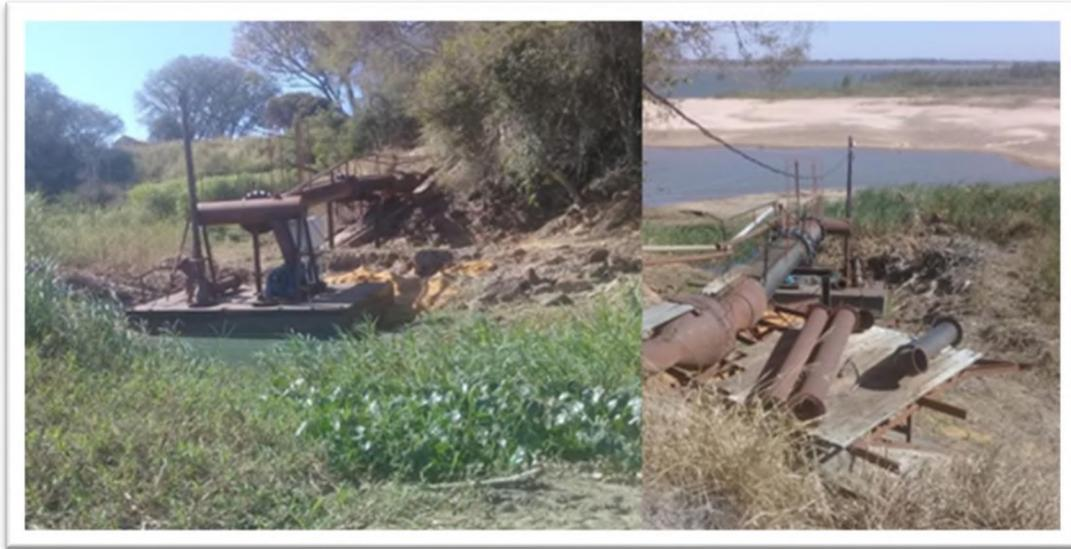
Figura 5. Toma de agua y bomba para riego de arroz sobre el río Paraná. En situación de bajante los productores muchas veces no podrán o será muy difícil adecuarse a la bajante (foto tomada el 28/07/2021 en Empedrado Corrientes).
