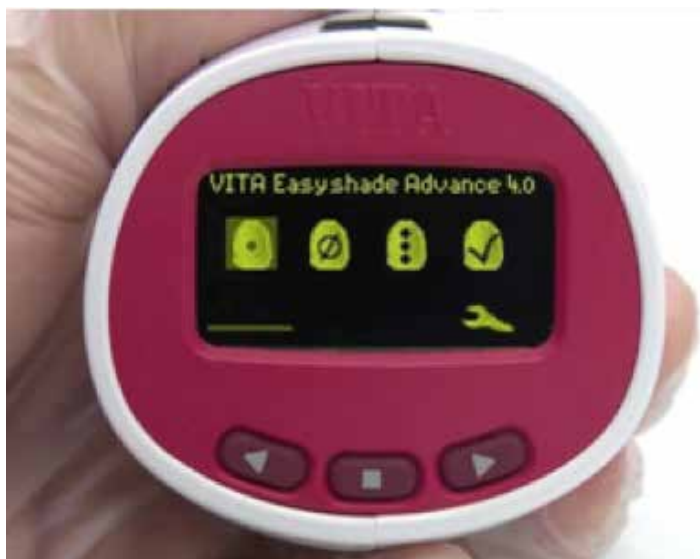
Figura 5- Diferentes Modos de Medición: medición del color básico, del color medio, de diferentes zonas y modo de verificar la restauración.
