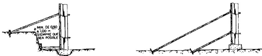
Fig. 24: Apuntalamiento de escamas (fuente: Apunte de estructuras de contención en suelo reforzado, UNLP, 2.010)
