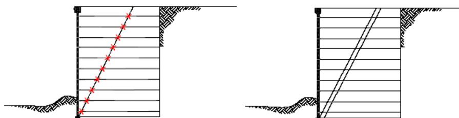
Fig. 34: Verificación a la rotura por tracción y a la rotura por arrancamiento (fuente: Apunte de estructuras de contención en suelo reforzado, UNLP, 2.010)
