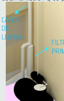
VISTA EN CORTE DEL FILTRO DE PRIMERAS AGUAS UTILIZADO EN NUESTRA VIVIENDA
