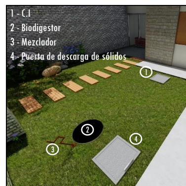
Imagen N° 115— Fotografía de biodigestor en vivienda. Elaboración propia.
