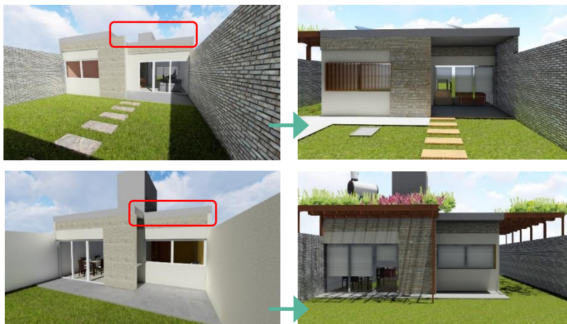
PROTECCION DE ABERTURAS CON PARASOLES VERTICALES – INCORPORACION DE ALEROS Y PERGOLA
