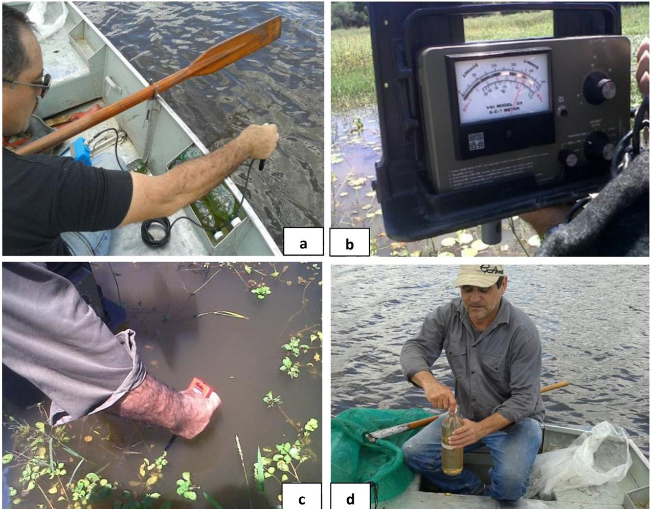
**Fig. 13:** Instrumentos utilizados para la medición de las variables físico-químicas del agua: a) oxímetro, b) conductímetro, c) peachímetro portátil, d) toma de muestra de agua para el análisis químico.
