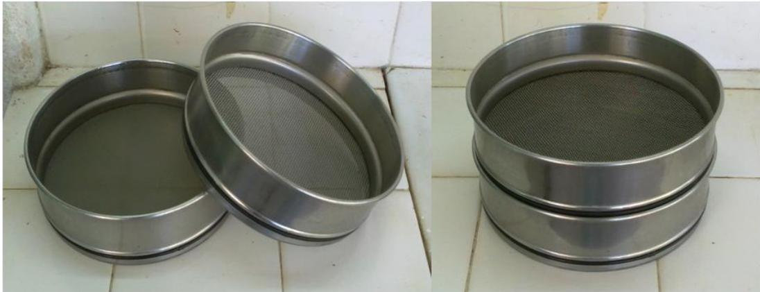
**Fig. 16:** Tamices de 1 mm (parte superior) y 500  $\mu\text{m}$  (parte inferior) de apertura de malla, para la separación de los invertebrados.
