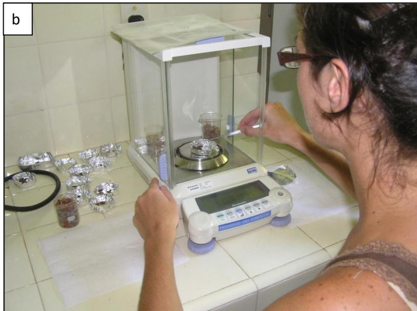
**Fig. 17:** Obtención del peso seco constante de los taxones seleccionados, a) secado en estufa, b) pesaje en balanza de precisión.
