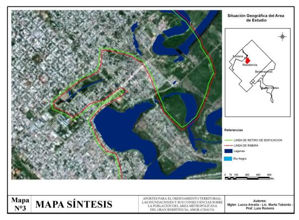
La línea de color rojo indica el punto de mayor creciente del agua, en tanto que la línea verde indica el retiro de la línea de construcción por lo tanto a partir de la misma no se debería instalar la población
