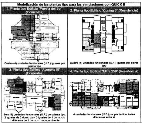
Tabla II. Planilla síntesis de la zonificación modelizada para la simulación con QUICK II de los cuatro edificios simulados.
