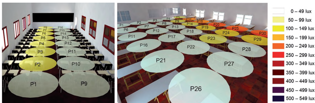
Figura 9. Izquierda: niveles de iluminación natural promedio por punto en diciembre, aula 6. Derecha: Niveles de iluminación natural promedio por punto en agosto, taller 7
