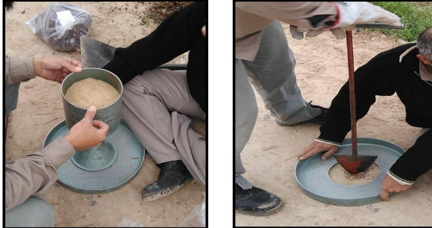
**Imagen 6.** Ejecución de ensayo de densidad– Imagen ilustrativa.
