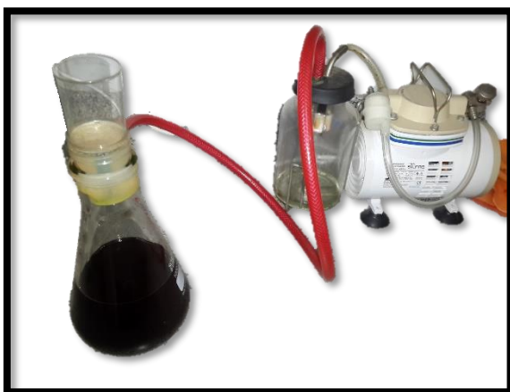
Figura 5. Equipo de filtración.
