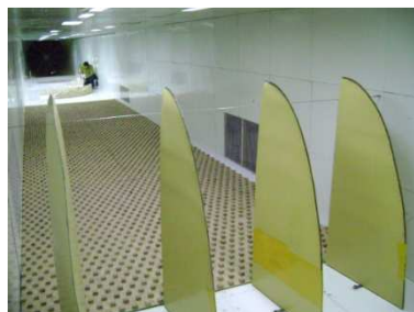
Figura 2. Generadores de Counihan, elementos de rugosidad para la simulación de la CLA y perfiles de velocidad característicos.
