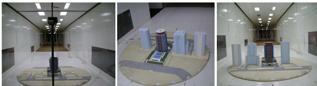
Figura 3. Modelo del edificio torre aislado y con reproducción del entorno inmediato en la cámara de ensayos del túnel de viento.
