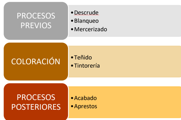
Figura 1.2. Etapas del proceso textil comúnmente utilizadas en la industria
