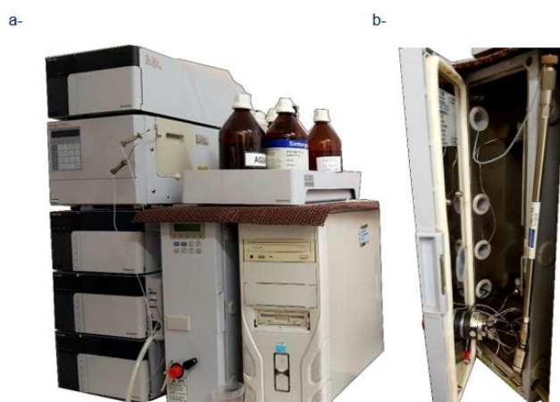
Figura 3.13. a-Equipo de HPLC modular Shimadzu, b- Compartimento horno y columna ODS.
