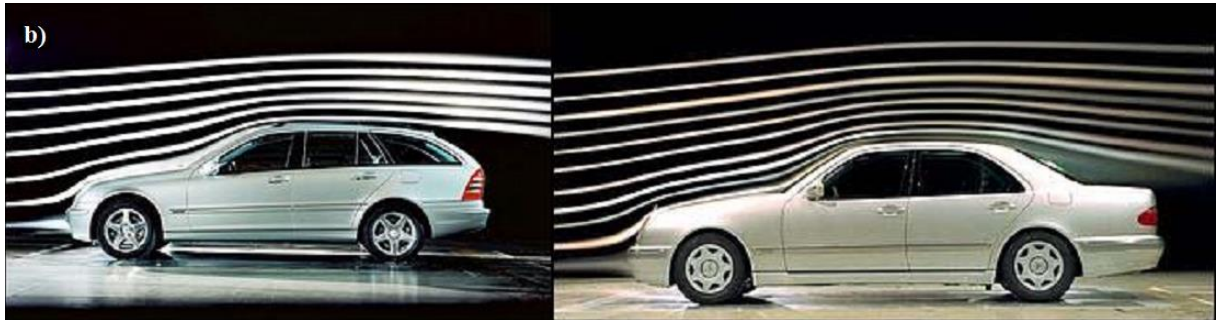
Figura 4.8 a) Capa Límite. b) Tubos de corriente que fluyen sobre automóviles de diferentes formas en túnel de viento
