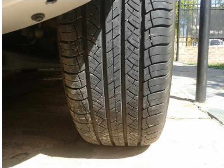
Figura 3.14: Surcos del neumático para canalizar el agua
