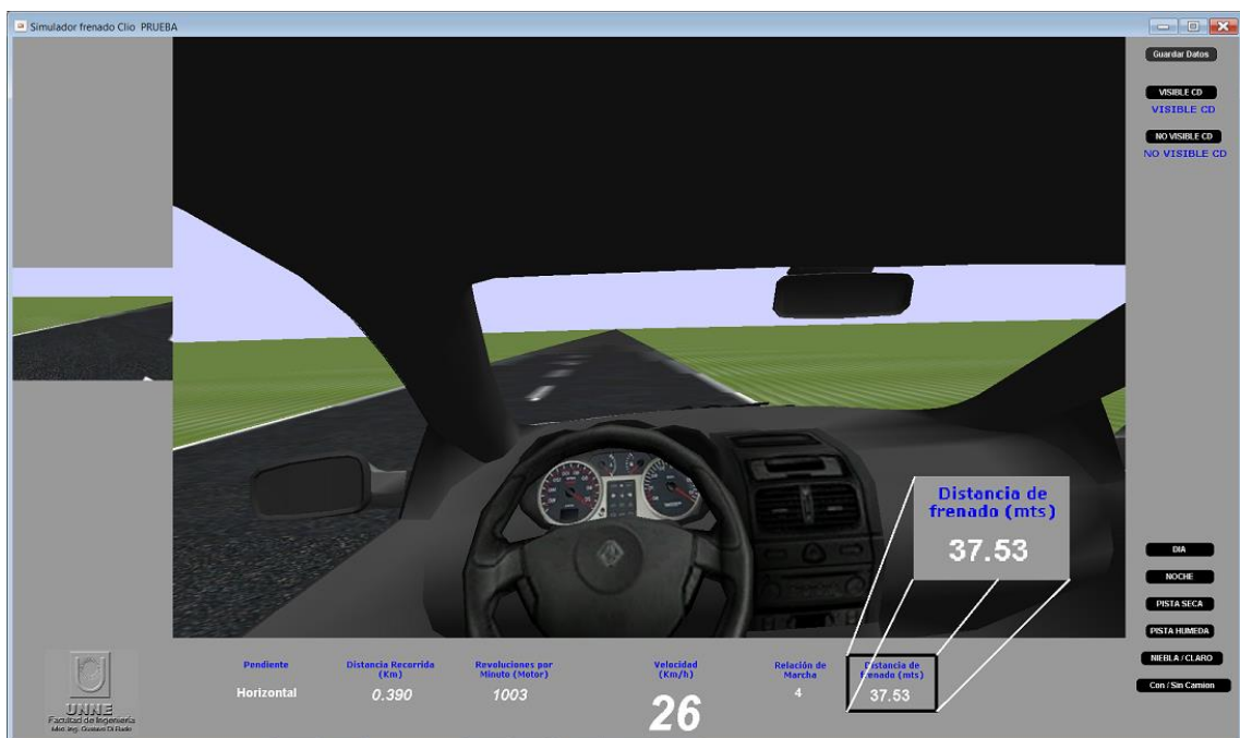
Figura 4.35: Cálculo de distancia de frenado en tiempo real
