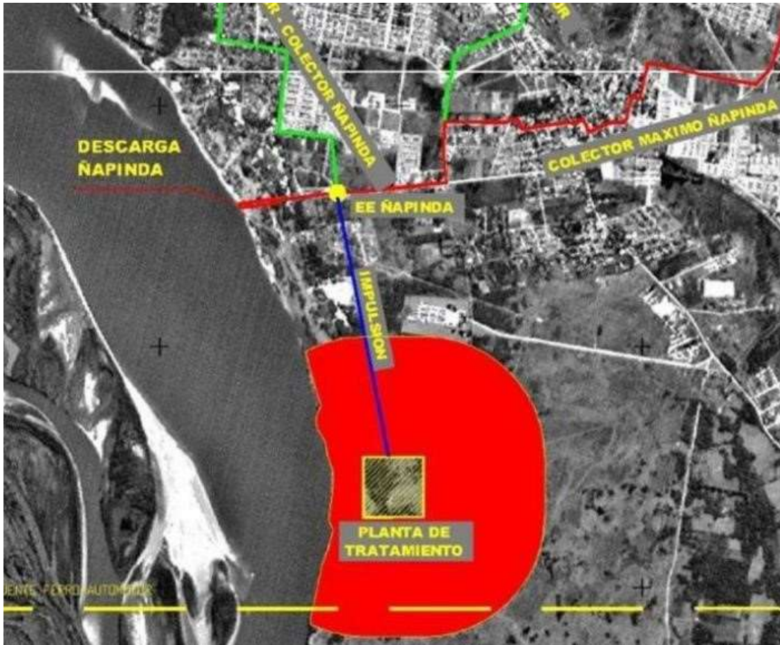
Figura 18. Ubicación actual de la descarga del líquido cloacal en la ciudad, y del proyecto de planta de tratamientos de líquidos cloacales licitada en el 2017 (fuente: Entidad “Aguas de Corrientes”), sin escala.
