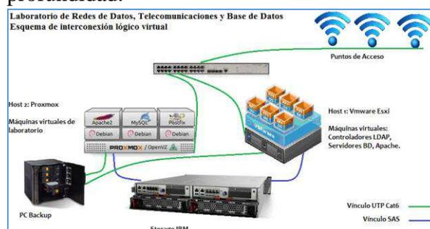
El dispositivo de Storage o Almacenamiento de Datos compartido en Red (SAN) estará integrado a los dos Hosts mediante conexiones SAS a 6.0 GBps, a los efectos de acceder a los volúmenes de datos compartidos, mediante protocolos NFS, iSCSI, SAS. Este equipo alojará las imágenes de máquinas virtuales a nivel Laboratorio, los volúmenes con datos de los Servidores SQL, las carpetas de usuario, entre otros.
